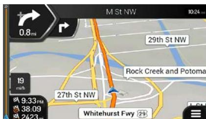
La manœuvre suivante est affichée dans un champ du coin supérieur gauche. Le type de manœuvre (virage, rond-point, sortie d'autoroute, etc.) et sa distance par rapport à la position actuelle sont affichés.
